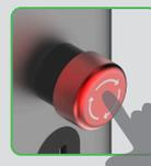
確認緊急情況解除後，旋轉緊急停止開關即可將其重置。
